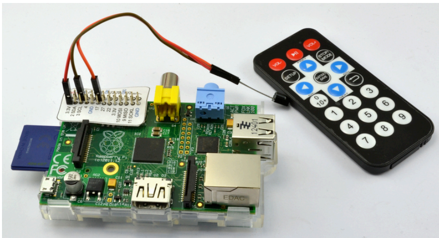
注：用红外线遥控器控制树莓派，作者八宝粥
